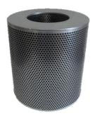
Kombinationsfilter zur hocheffektiven Reinigung der Luft von partikulären und gasförmigen Verunreinigungen. Beseitigt Gerüche, Lösungsmitteldämpfe und andere Schadstoffe. Aktivkohlevolumen: ca. 33 Liter Mit Schwebstoff-Vorfilter Filterklasse F5
