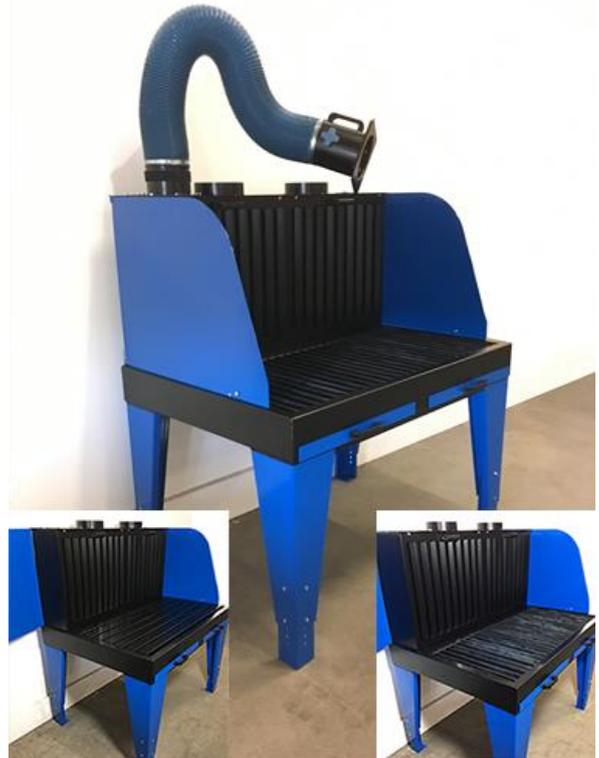
**Grobes Schleifen.** Für grobes Schleifen ist der Maxi-Mesa mit einer Auflage aus vertikalen 40x5mm Flacheisen lieferbar. Heiße Partikel und Funken fallen nach unten in die Staub-Schubladen. Der Hauptluftstrom geht durch die Rückwand-Absaugung und, falls montiert, durch den Absaugarm, der Staub, heißen Rauch und Gase erfasst.
